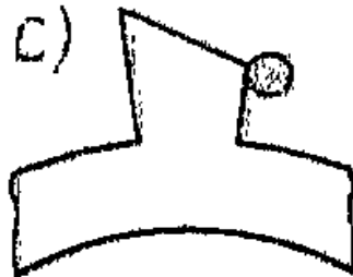
Rys. N.32. Spoczynek w wychwycie kołkowym: a) prawidłowy, b) za duży, c) za mały
